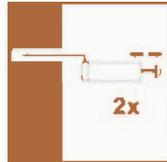
4. Soplar dos veces desde el fondo del orificio. Coloque el cepillo del tamaño adecuado ( $>db_{min}$  Tabla B2 o B3) en una taladradora o un desarmador eléctrico, limpie el agujero dos veces y, finalmente, sople el agujero dos veces.
