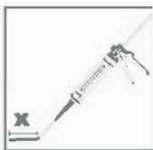
5. Antes de colocar el mortero en el orificio de anclaje, exprima por separado un mínimo de tres pasadas completas y deseche los componentes adhesivos que no estén uniformemente mezclados hasta que el mortero muestre un color gris uniforme.
