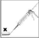
2. El adhesivo inicial no es adecuado para la fijación del anclaje. Antes de dosificar en el orificio de anclaje, exprima por separado un mínimo de tres pasadas completas, para los cartuchos de tubos de aluminio seis pasadas completas y deseche los componentes adhesivos que no estén uniformemente mezclados hasta que el mortero muestre un color gris uniforme.
